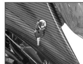
Sejmutí sedla: Po odemknutí zámku a jeho stlačení odklopte zadní část sedla.
