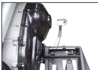
Stlačením pedálu zadní brzdy aktivujete zadní brzdy.
