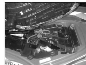
Chcete-li získat přístup baterii nebo vyměnit pojistky, musíte sejmut sedlo. Pod sedadlem najdete pojistku (viz obrázek). Náhradní pojistka je též přiložena. Pozor na poškození kabelů el. Instalace.
