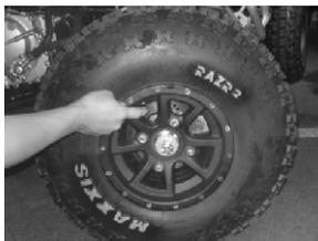
**UPOZORNĚNÍ:** Čtyřkolka je vybavena bezdušovými plášti a ty by se nikdy neměly opravovat. Poškozené pneumatiky proto vyměňte.
