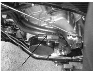
V případě, že motor nenastartuje pomocí elektrického startéru, je nutné k nastartování použít záložní ruční startér: Přeřaďte na neutrál (N) a uchopte držák startéru, který se nachází na krytu motorového dynama. Vytáhněte šňůru, dokud neucítíte odpor způsobený startérem. Poté za ni zatáhněte silou, dokud motor nenastartuje.
